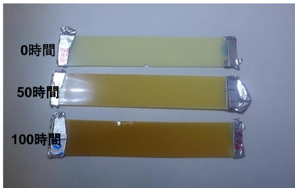
図1 対候性試験における各試料の写真
